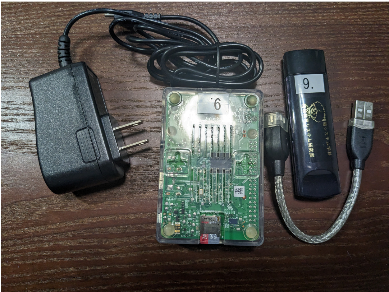
図 4 計測機器の写真。中央に写っているプラスチックケースは Raspberry Pi である。黒いコンセントに差し込める形状のものが Raspberry Pi の AC アダプタである。黒い細長い形状のものが USB で接続できる無線 LAN アダプタである。ケーブルは USB から映像の出力ができ、HDMI から映像の入力ができるケーブルである。
