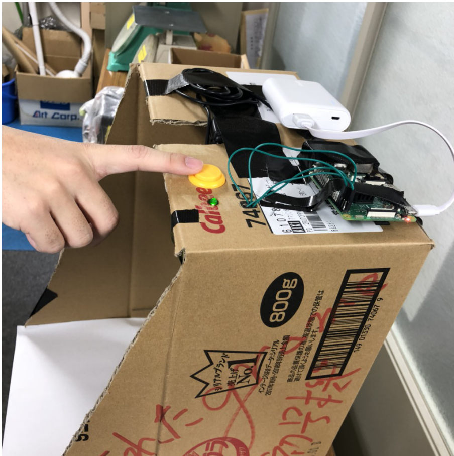
図 7 忘れ物管理支援システムの組み込みシステムの全体像である。段ボールの筐体には Raspberry Pi3 と Web カメラ、入力のプッシュボタンと入力待ちを表す LED を取り付けている。
