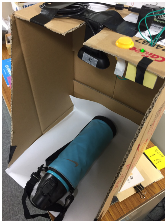
図 15 水筒を撮影ブースに乗せるが全体に収まりきらず、筐体からはみ出している。
