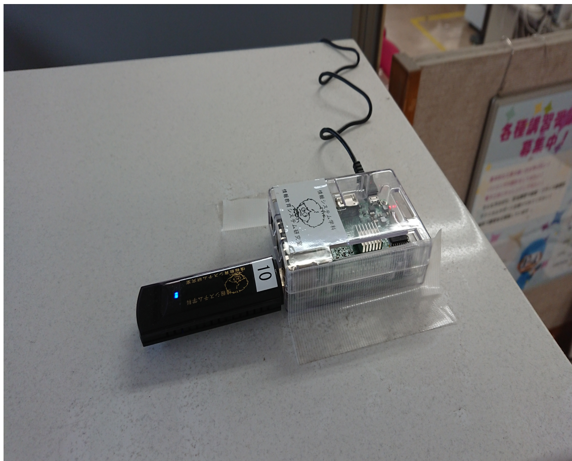
図 7 計測機器の写真である。図中に写っているプラスチックケースが RP である。その計測機器に USB 接続しているのは無線 LAN アダプタである。電源からの距離と AC アダプターのコードの長さの関係上、設置場所から落ちる可能性があるため、養生テープで固定している。
