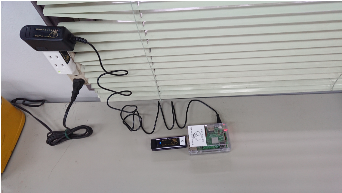
図 3 計測機器設置場所の 1 つである 7 号館での設置時の写真である。図中に写っているプラスチックケースは Raspberry Pi である。その Raspberry Pi に USB 接続されている機器は無線 LAN アダプタである。図中左側の電源タップに接続されているのが、Raspberry Pi の AC アダプタである。AC アダプタを含め、上述した機器を纏めて計測機器とする。計測機器設置場所のコンセントの差し込み口を埋めないために、電源タップを持ち込み使用している。
