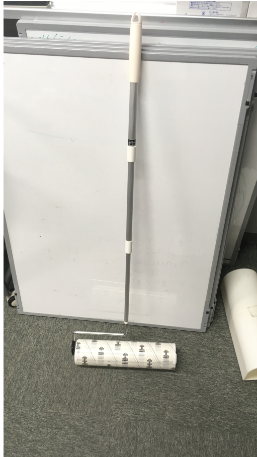
図2 粘着カーペットクリーナー 新品時の円柱の直径約 88mm、円柱の幅約 320mm、持ち手の長さ約 940mm
