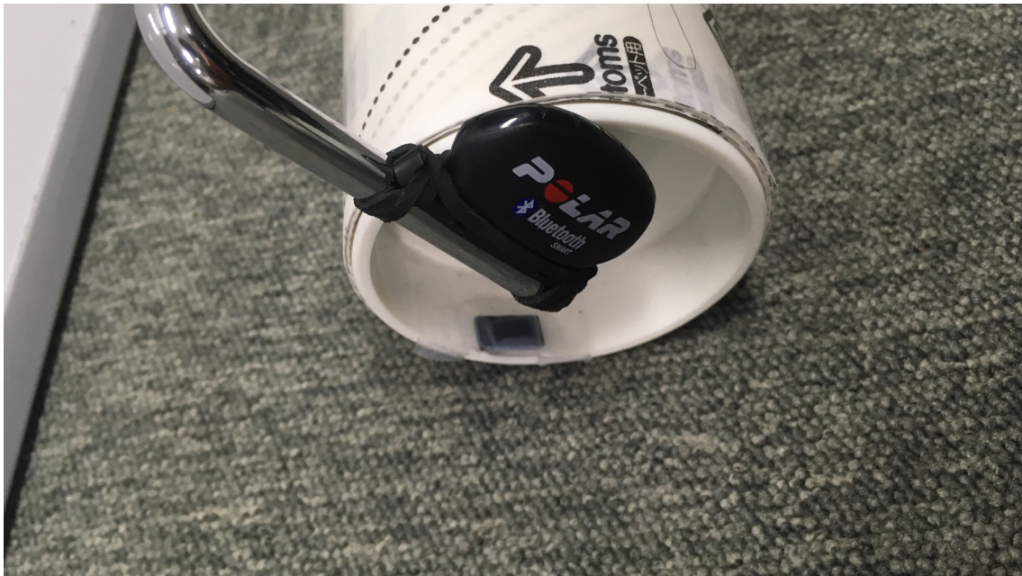
図 6 ケイデンスセンサーと磁石、磁石がケイデンスセンサーの横を通りすぎると反応し Polar M450 にデータを送る
