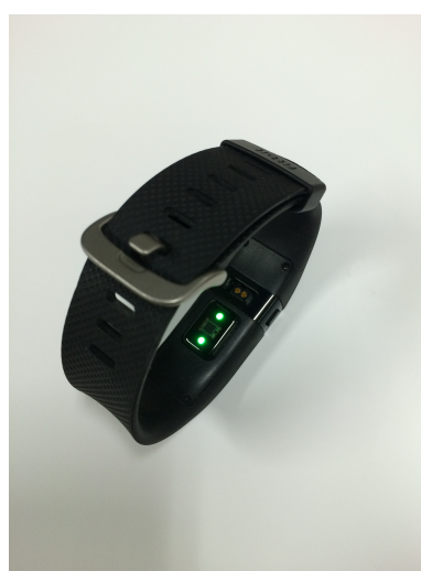
図 9 Charge HR の背面。内側に見える 2つの点が脈拍を測るための LED ライトである
