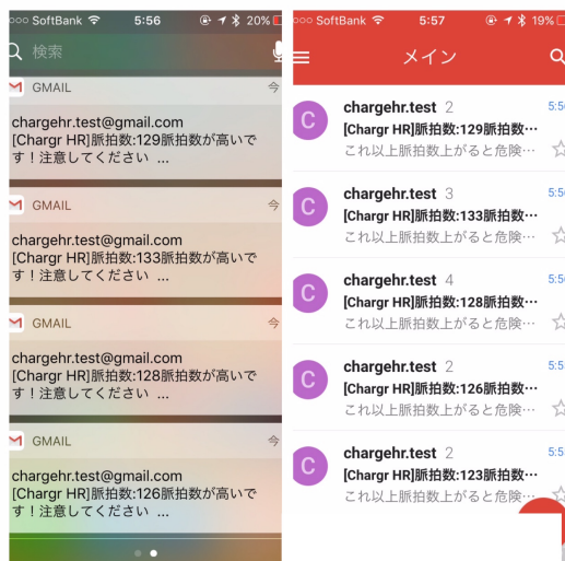
図 15 頻脈より直前に脈拍数 120 回/min を超えた時の受信メール。上から脈拍数 129 回,133 回,128 回,126 回/min が確認できる
