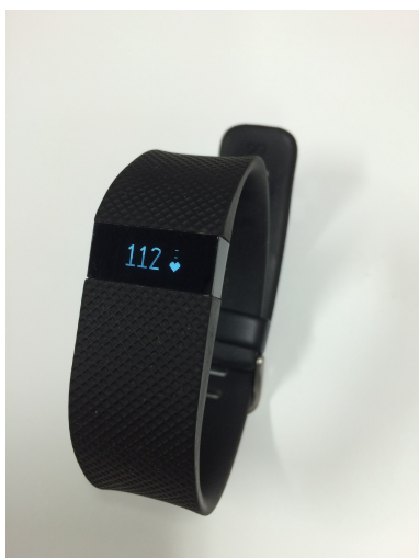
図 8 Charge HR の表面。ディスプレイにはリアルタイムの脈拍数が表示される
