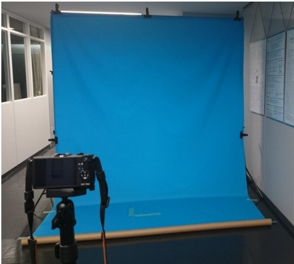
図 6 カメラの高さ 120cm、ユーザーまでの距離 300cm の撮影スタジオ
